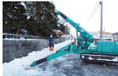
大型クレーン吊による伐採作業状況
